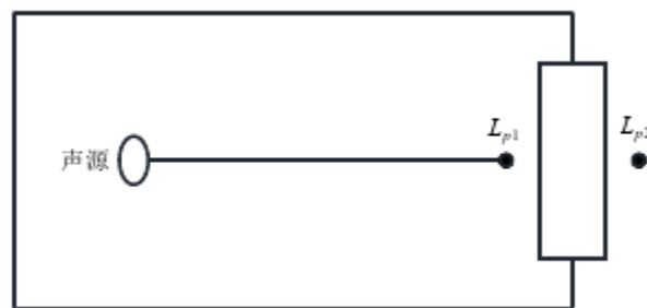
图 3 室内声源等效为室外声源图例
