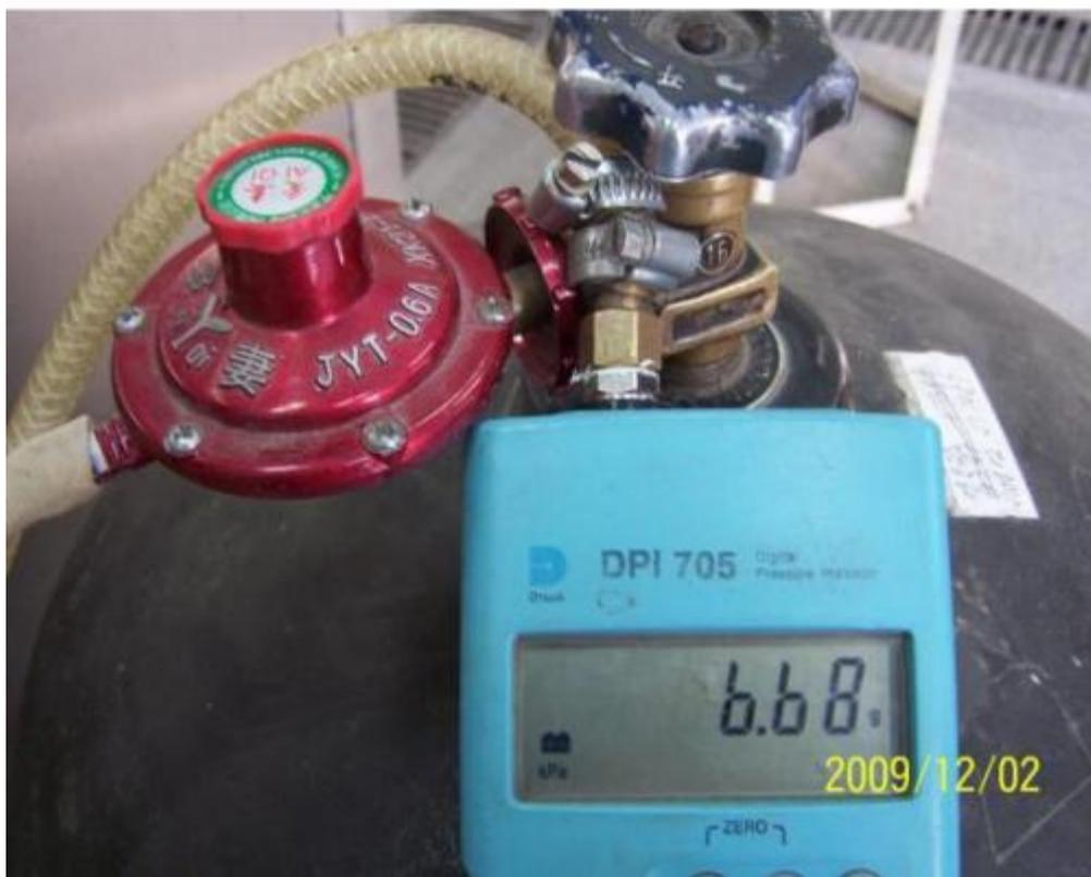
对瓶装液化石油气调压器除重点检查是否存在可调节输出压力大小旋钮的结构外，还应查验产品标志、警示内容是否完整，包括以下信息：制造厂名称、商标、型号、生产日期、使用年限及燃气流动方向；带有压力或流量安全装路的调压器标志应在明显位路以不易磨灭的形式标有“超压切断”或“低压切断”或“过流切断”字样。其中带有超压切断装路的还应有额定切断压力；商用瓶装液化石油气调压器应在明显位路以不易磨灭的形式标有“禁止家用”字样。
