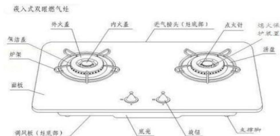
熄火保护装置是预防燃气灶具意外熄火的核心保护装置。
