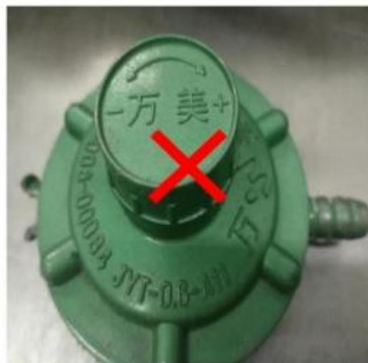
下图为某起事故中使用的不合格瓶装液化石油气调压器（可调节），出口压力实测值为 6.68 kPa，超出标准要求的 2.8kPa 两倍以上，极易导致燃气器具一氧化碳排放超标，且有引起燃气泄漏
