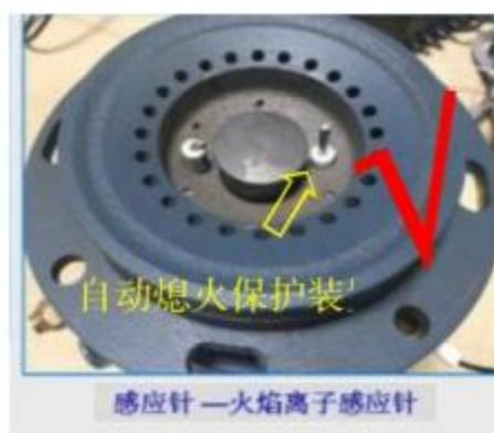
现场检查重点：一是查验炉头上是否有感应探针，感应探针下是否有熄火保护装置(检查中曾发现部分产品炉头中装有“感应探针”，但“探针”并没有连接灶具，是假的熄火保护装置)。发现无熄火保护装置或点燃灶具火苗意外熄灭时，未在 60 秒以内自动切断燃气的，应初步判定该产品不符合 GB16410 《家用燃气灶具》国家标准要求。
