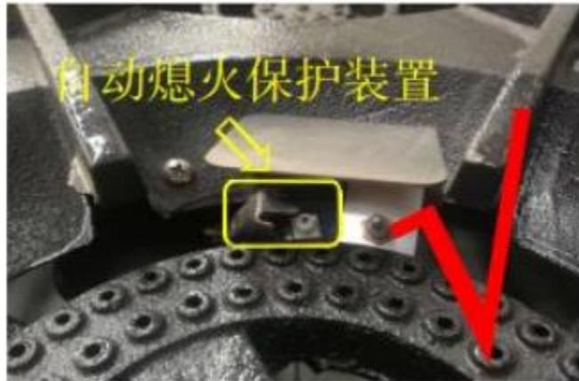
对商用燃气灶具产品除重点检查是否安装熄火保护装置外，还应查验产品铭牌、警示标识内容是否完整，包括以下信息：
